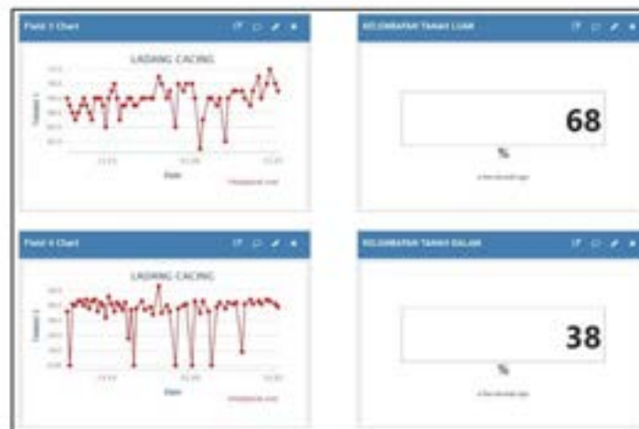
Rajah 6: Bacaan suhu dan kelembapan tanah luar serta dalam bagi sistem TerraNest yang direkodkan melalui platform ThingSpeak
